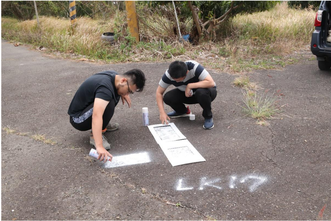
圖 15 地面控制點佈設工作照。
