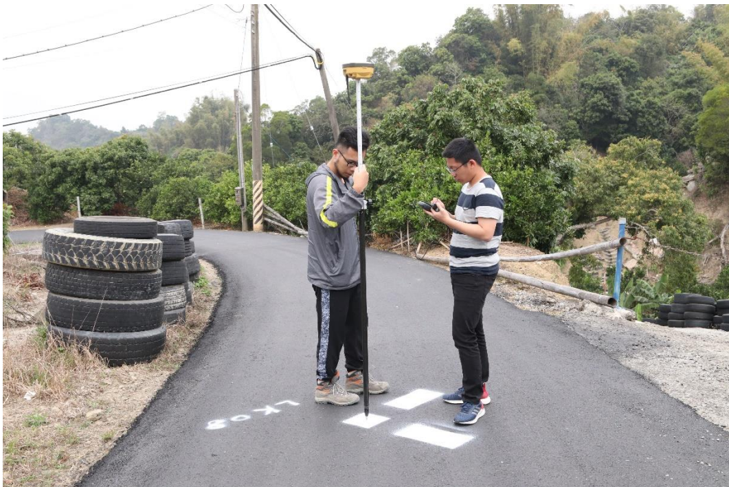
圖 16 以 VBS-RTK 量測地面控制點之工作照。
