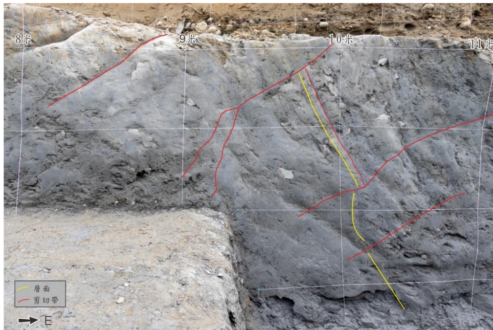
圖 31 槽溝北牆 8~11 公尺處的剪切帶及被截斷的砂岩層。
